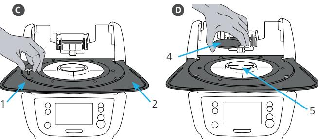
C Sichern Sie nun die Brenngut-Ablageplatte mit den zwei Befestigungsschrauben (1).
